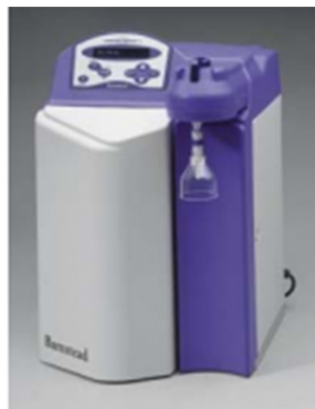
Fig 3-4 NANOpure Diamond, Barnstead D11911
